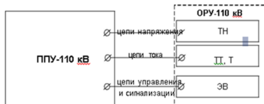
Рисунок 2.2. - Связь аппаратуры АСТУ с высоковольтным оборудованием
