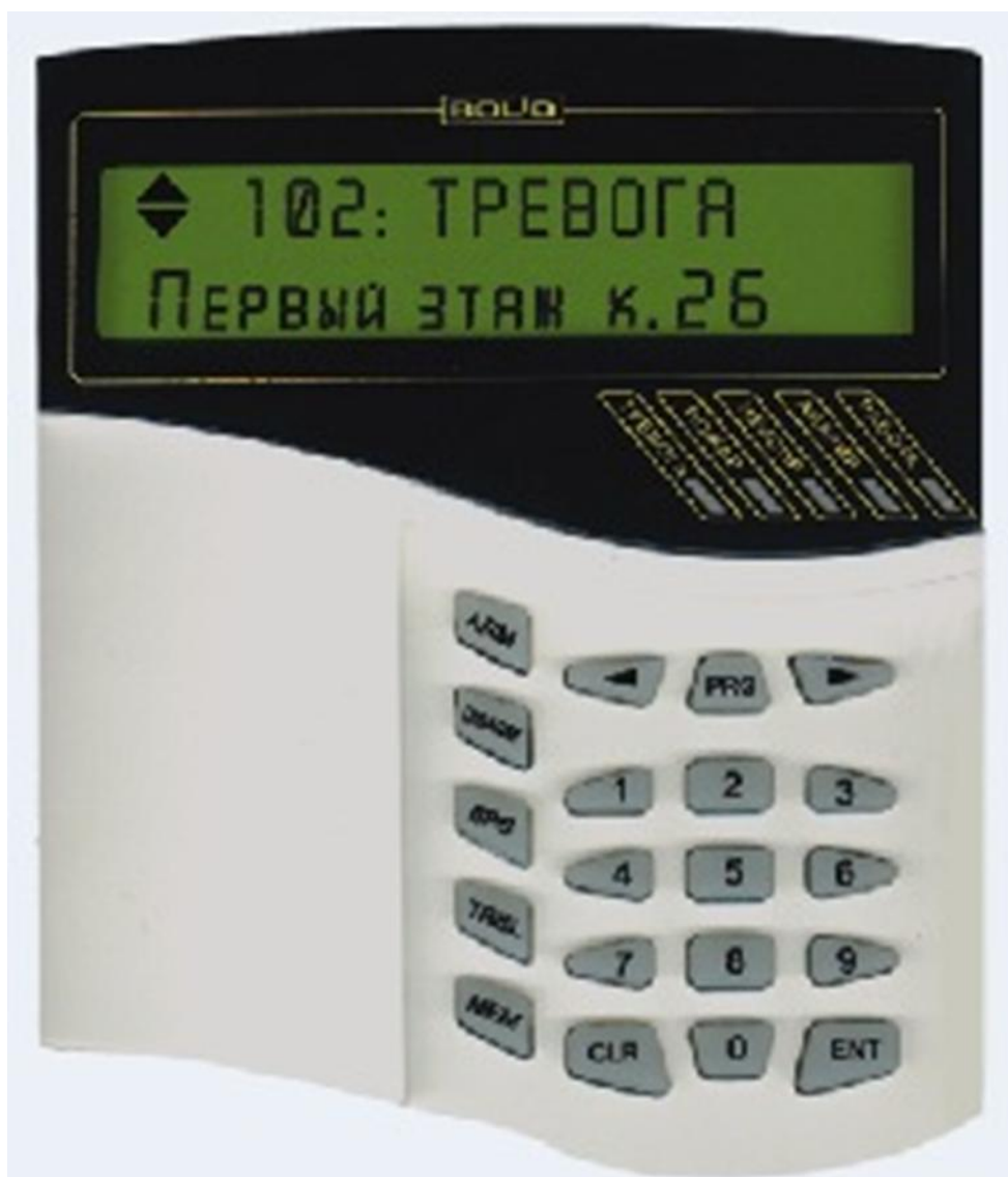
Рисунок 7-Пульт управления пожарной системой
