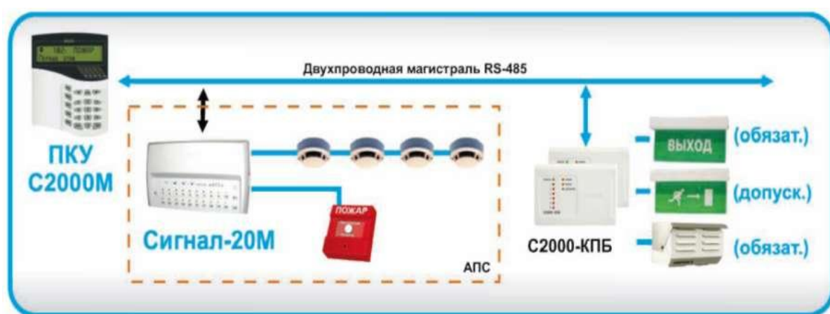
Рисунок 30- Структурная схема системы светового оповещения фирмы болид
