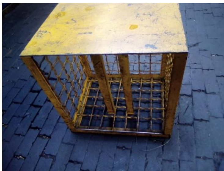
Рисунок 43 - Внешний вид защитного ограждения для обкатки двигателей
