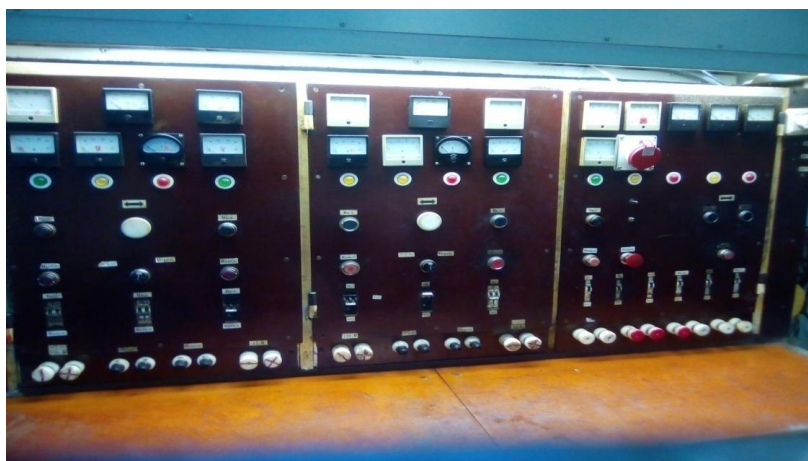
Рисунок 10 - Стенды для тестирования электродвигателей УГМ ДОРТО
