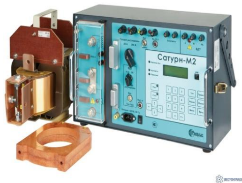
Рисунок 16 – Прогрузочный стенд для автоматических выключателей
