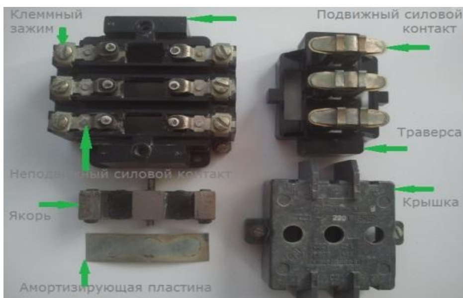
Рисунок 44. Внешний вид элементов пускателя ПМА после ревизии
