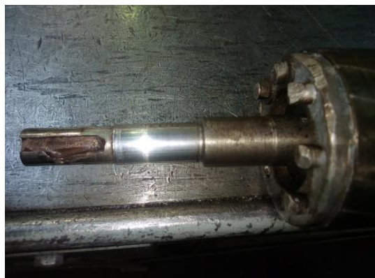
Рисунок 12 – Деформированный шпоночный паз электродвигателя, полученного со склада.
