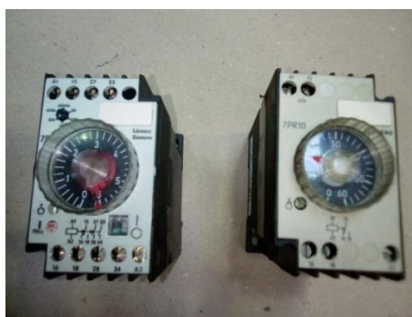
Рисунок 7 - Реле времени ф. Siemens (справа) и его аналог (слева)
