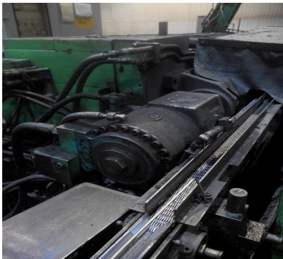
Рисунок 3 - Система вращения ведущего круга с гидроприводом.
