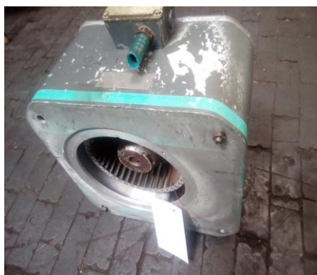
Рисунок 41 – Узел независимой вентиляции специальных асинхронных двигателей ф. Siemens
