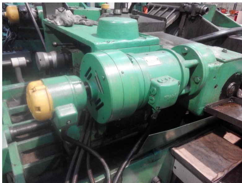
Рисунок 4 - Система вращения ведущего круга электроприводом с двигателем постоянного тока.
