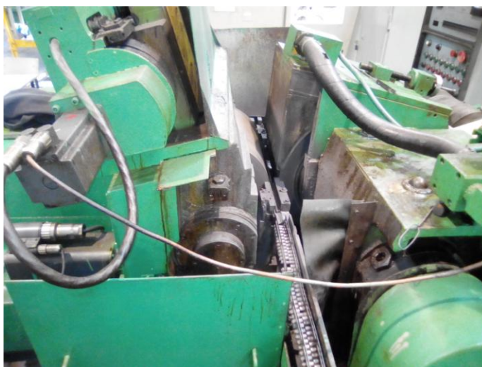
Рисунок 6 - Система электропривода ведущего круга с серводвигателем.
