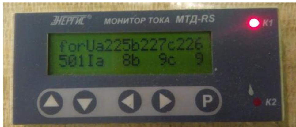
Рисунок 31- Монитор тока двигателя МТД-RS производства компании
