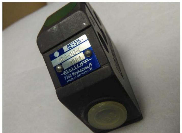
Рисунок 10- Индуктивный датчик приближения Balluff BES 516-161-10-L
