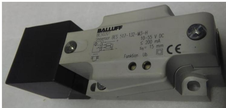
Рисунок 11- Индуктивный датчик приближения Balluff BES 517-132-M3-H
