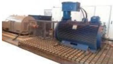
Рисунок 22- Станция испытательная электромашин переменного тока мощностью от 100 до 1000 кВт РИФЖ 441323.001
