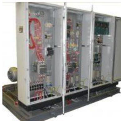
Рисунок 23- Стенд для испытания асинхронных электродвигателей мощностью до 100 кВт РИФЖ 441249.002
