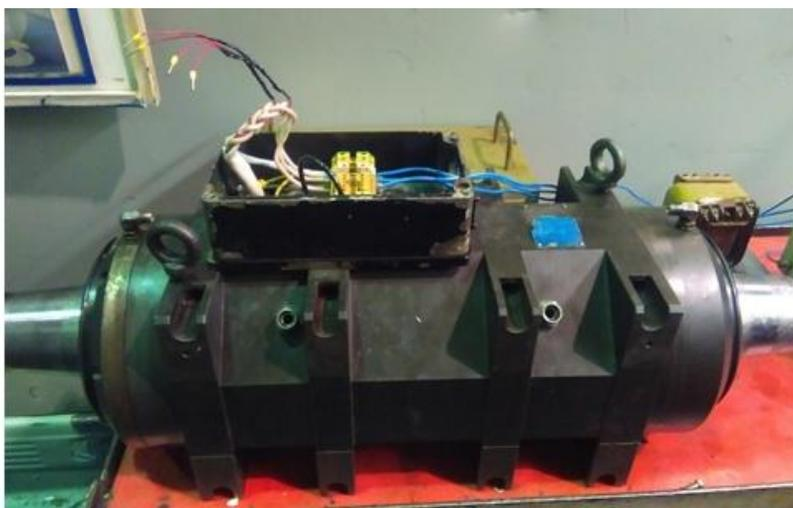
Рисунок 2- Мотор-шпиндель
