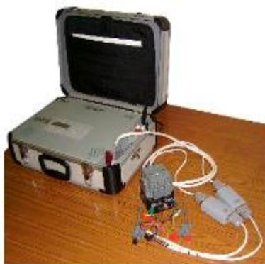
Рисунок 24- Стенд контроля электромеханических реле «Крона-606.01»
