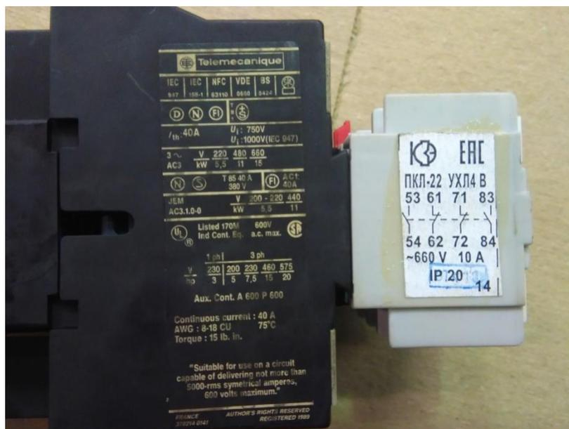
Рисунок 4- Магнитный пускатель серии Telemecanique
