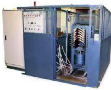
Рисунок 21- Многоярусная установка для о прессовки и испытаний секций якорных катушек тяговых электродвигателей РИФЖ 043261.002
