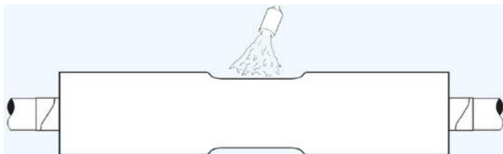
Рисунок 3.18 – Усаживание наружного термоусаживаемого кожуха
