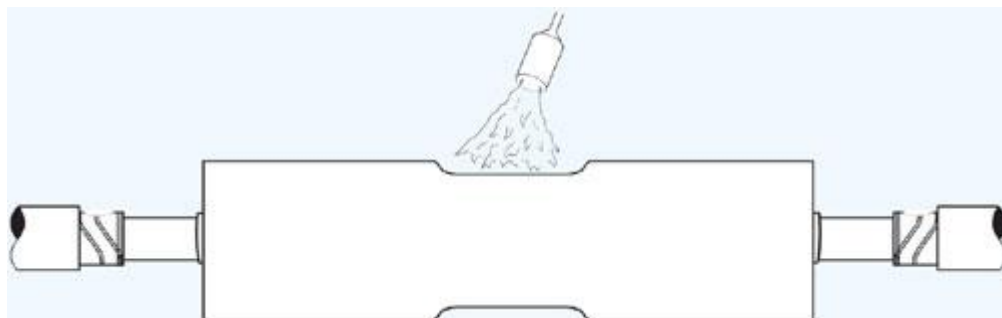
Рисунок 3.15 – Усаживание внутреннего термоусаживаемого кожуха
