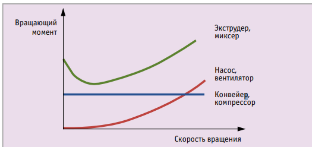
Рис. 2. Механические характеристики типичных нагрузок
