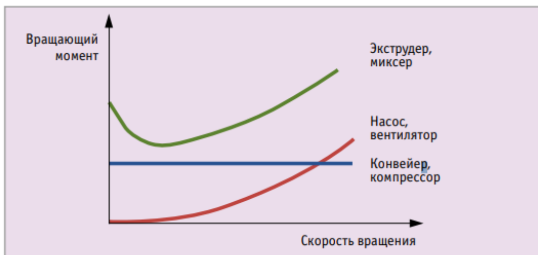
Рис. 2. Механические характеристики типичных нагрузок
