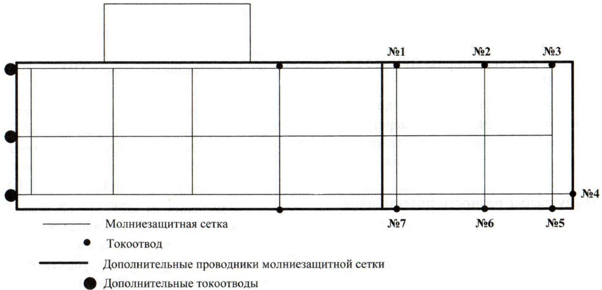
Рисунок 30 – Схема молниезащиты здания ППУ-110кВ
