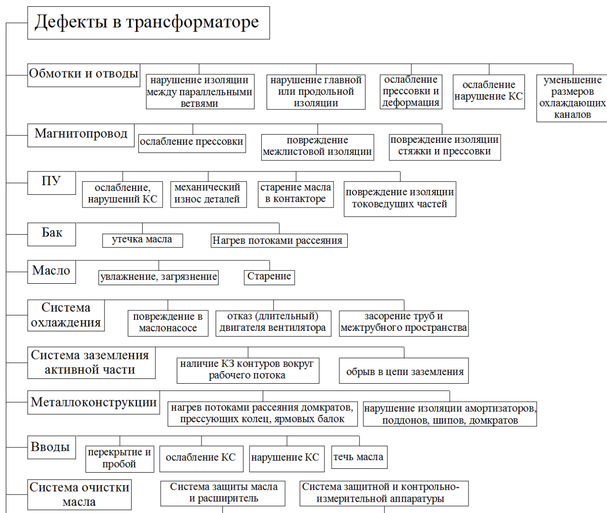
Рисунок 1- Схема классификации дефектов силового трансформатора.
