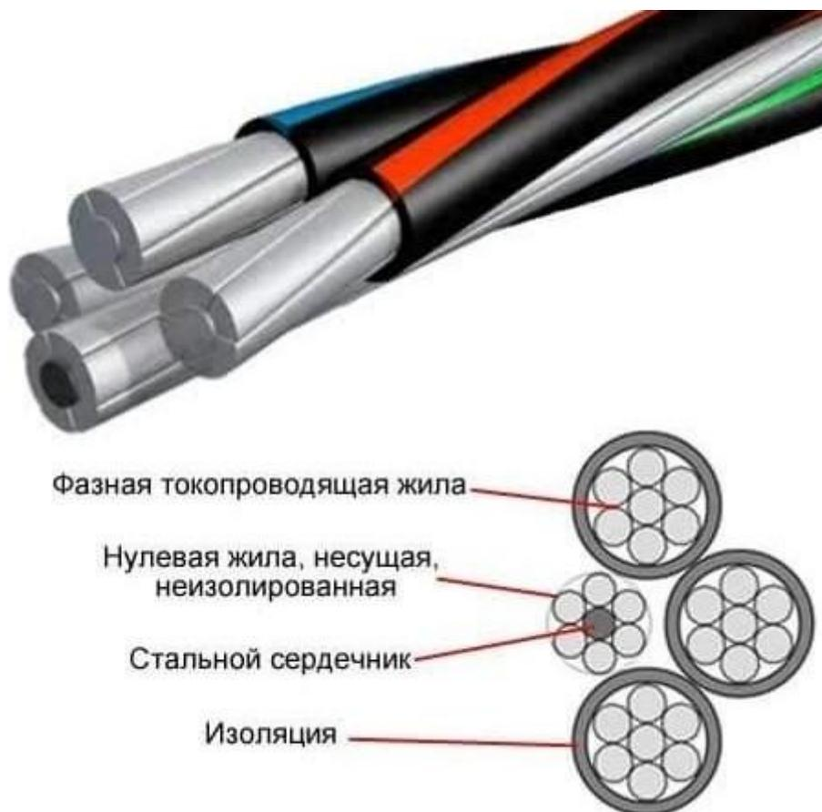
Рисунок 2 – Внешний вид и структура провода СИП 1
