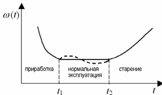
Рисунок 3.1 – Кривая параметра потока отказов элемента на протяжении жизненного цикла
