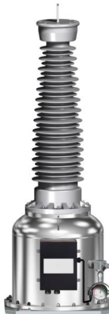
Рисунок 14.1 - Внешний вид ЗНОГ-110П-У1, 110/3;0,1/3;0,1/3;0,1 класс точности вторичных обмоток - 0,2/0,5/3Р
