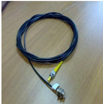
Рисунок 10.2 - Волоконно-оптический датчик дуговой защиты на основе полимерного кабеля
