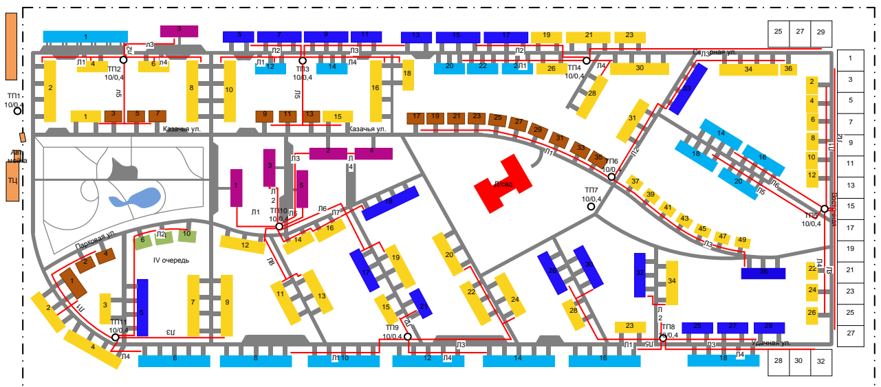
Рисунок 5.2 – План расположения ТП вариант 1, а) сети 10 кВ, б) сети 0,4 кВ
