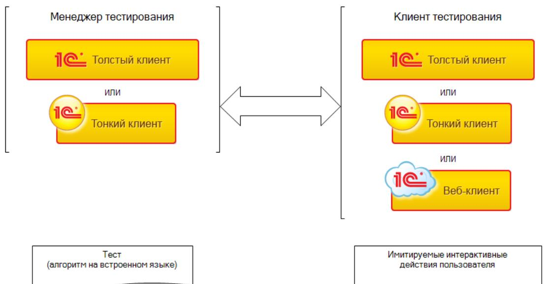
Рисунок 3.8 - Схема механизма автоматизированного тестирования в концепции «1С: Предприятие 8»
