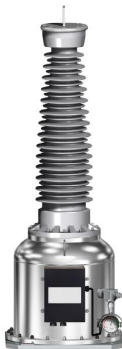
Рисунок 15.1 - Внешний вид ЗНОГ-110П-УХЛ1, 110/3;0,1/3;0,1/3;0,1 класс точности вторичных обмоток - 0,2/0,5/3Р
