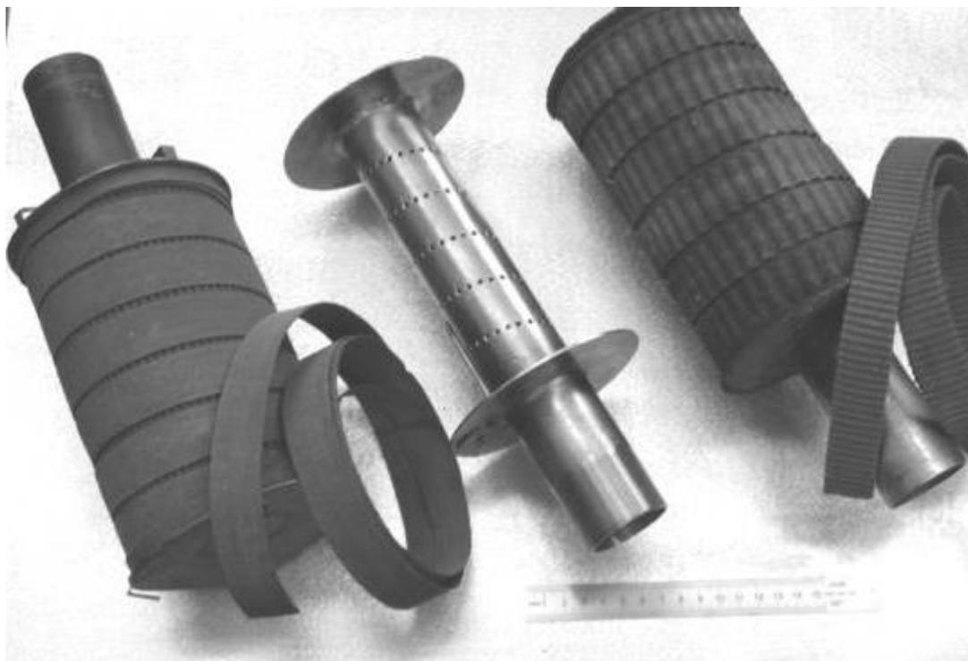
Рисунок 3.2 - Общий вид генератора синтез-газа, газораспределительной трубки, плоских и гофрированных лент из армированного порометаллического катализатора.
