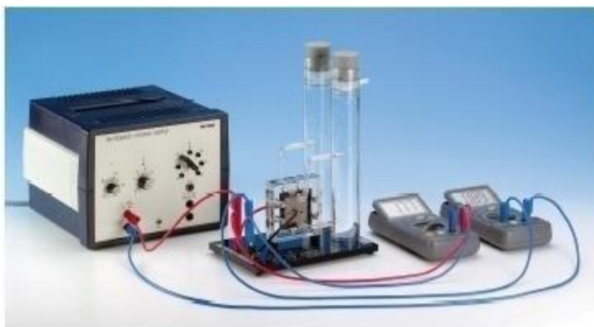
Рисунок 18 – Лабораторная установка для получение водорода при помощи электролизера, работающего от генератора[9]
