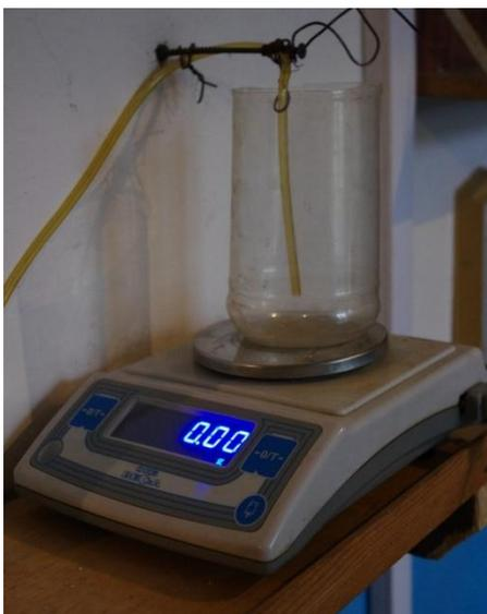
Рисунок 2.3 – Весы лабораторные VM 512
