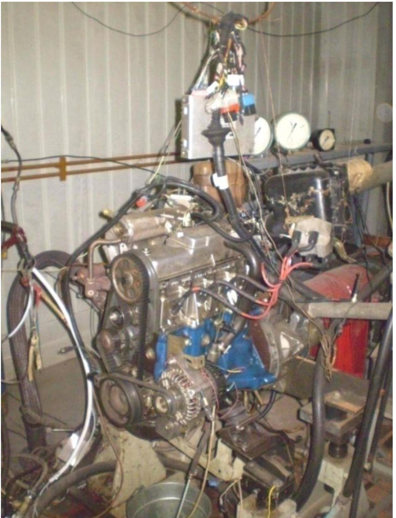
Рисунок 2.3 – Общий вид экспериментального стенда с двигателем ВАЗ-2111
