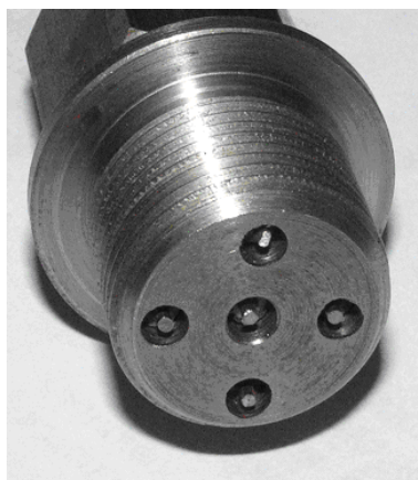
Рисунок 2.3 – Пяти электродный датчик ионизации применяемый в УИТ-85
