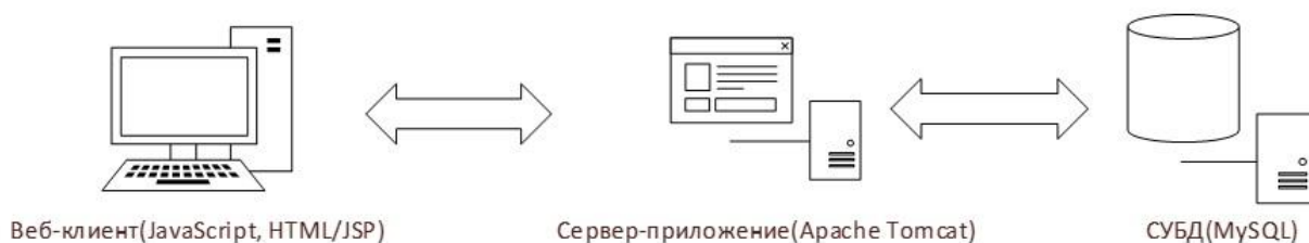
Рисунок 3.1 – Трёхзвенная клиент-серверная структура
