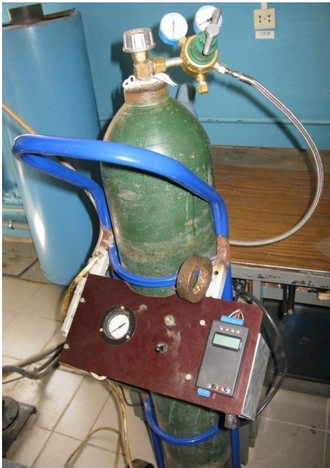
Рисунок 12 – Общий вид системы подачи водорода в УИТ-85
