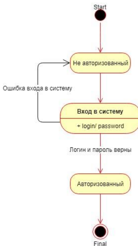
Рисунок 2.4 – Диаграмма состояний проверки логина и пароля
