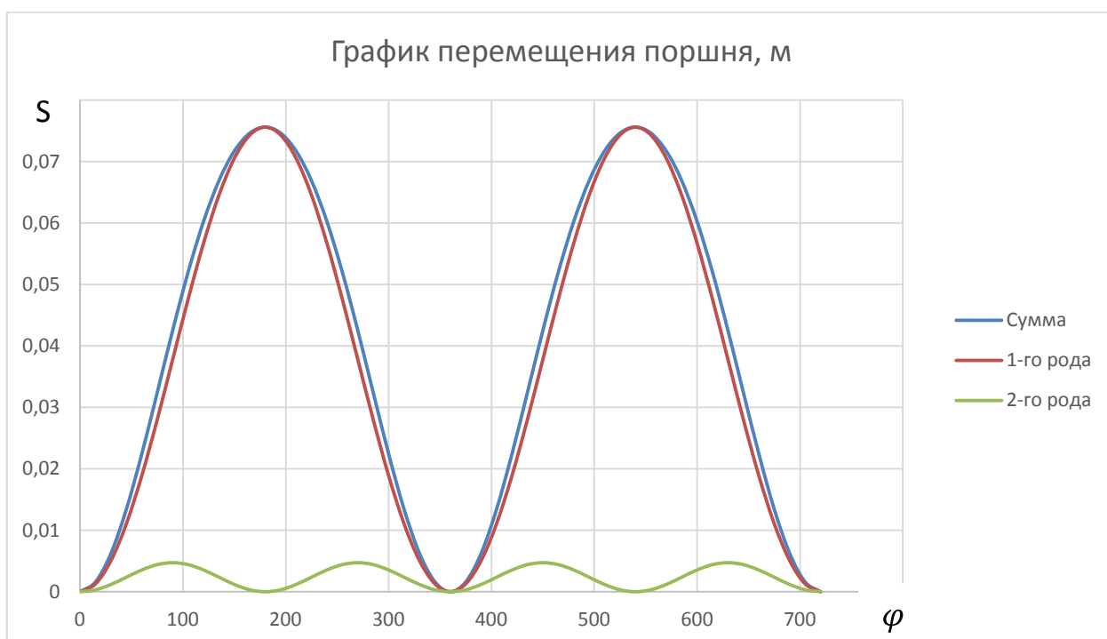
Рисунок 4.1– Зависимость перемещения поршня от угла П.К.В.
