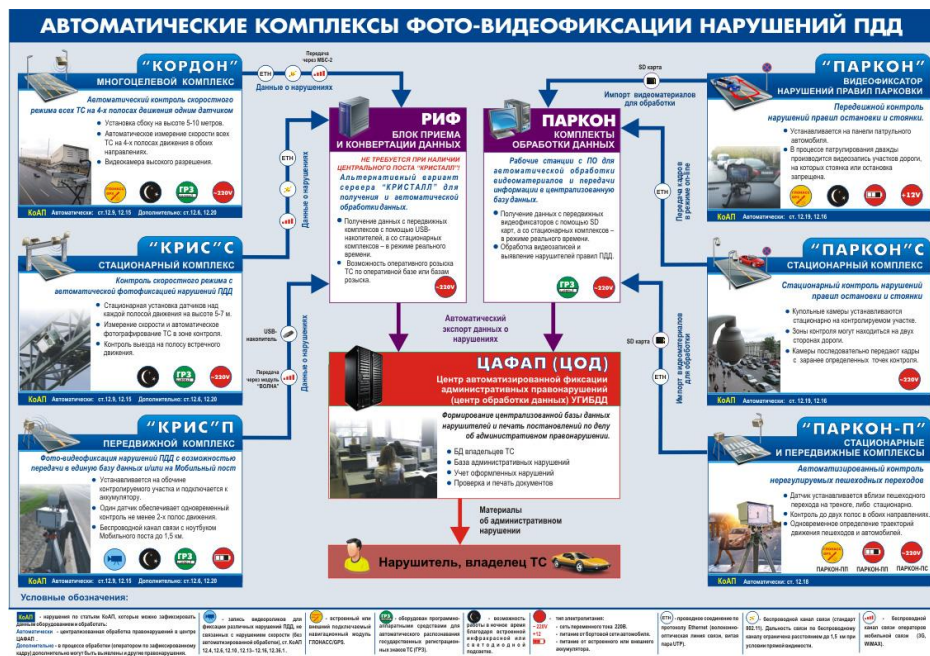
Рисунок 4 – Схема работы автоматических комплексов фото- и видеофиксации нарушений ПДД
