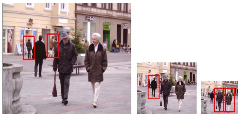
Рисунок 35 – Метод скользящего окна с масштабированием
