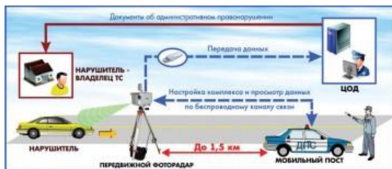
Рисунок 3 – Принцип работы радара КРИС-П
