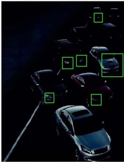
Рисунок 43 – Эффект детектирования при сверхнизкой освещенности
