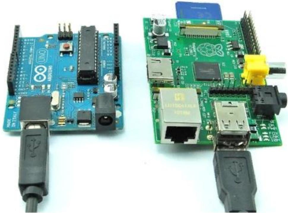
Рисунок 11- Arduino и Raspberry Pi
