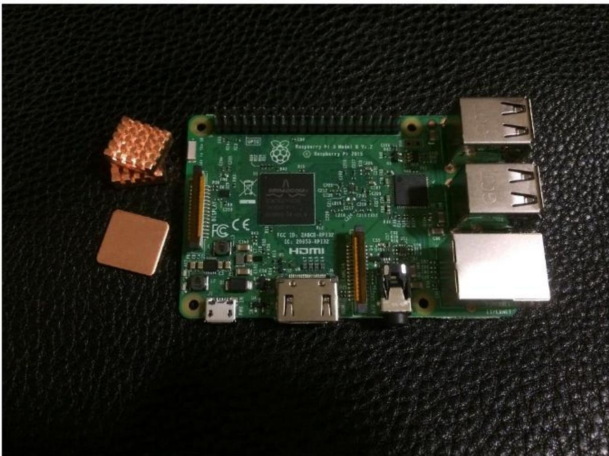
Рисунок 20- Установка радиаторов
