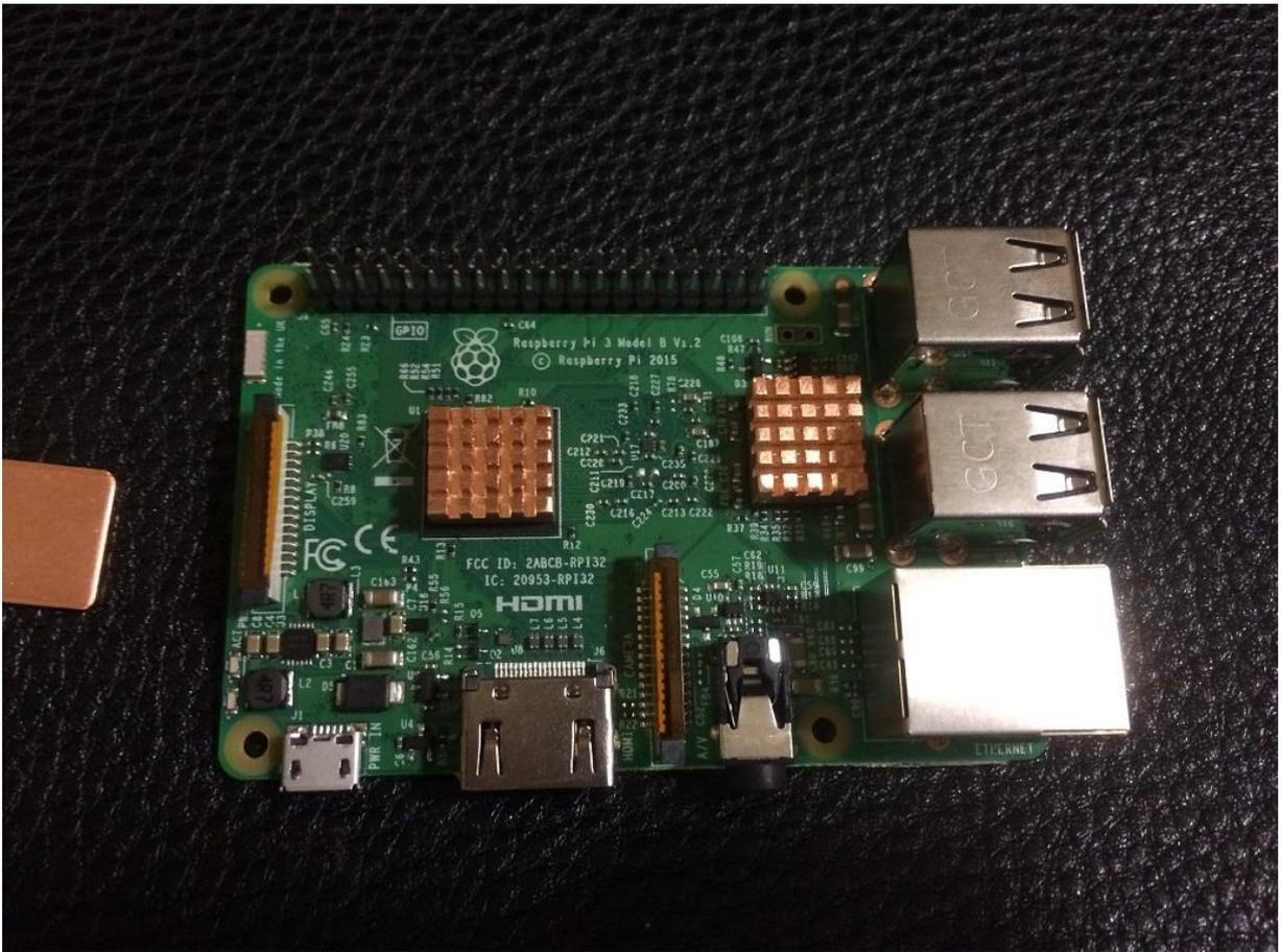
Рисунок 21- Установка радиаторов
