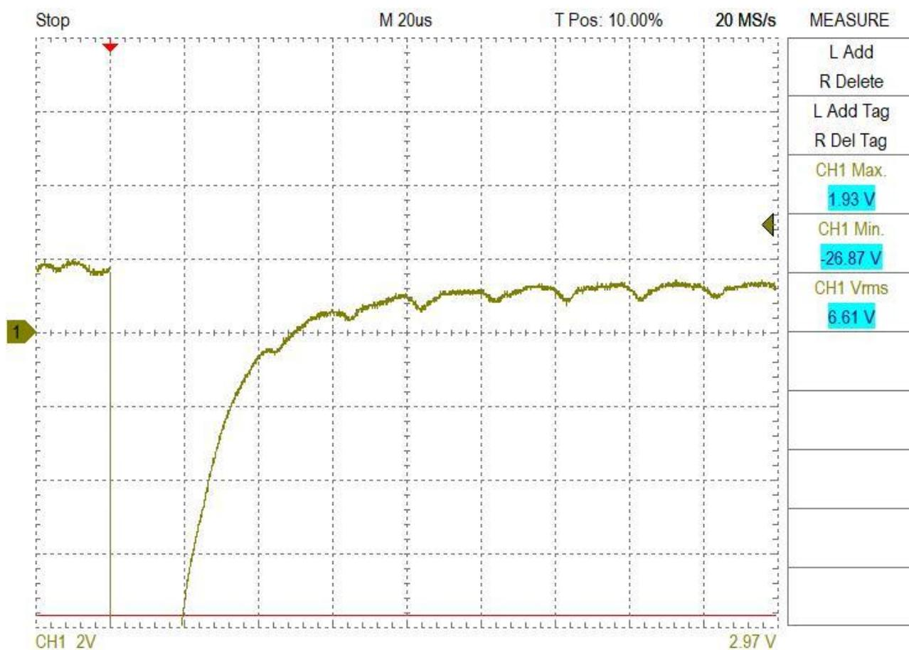
Рисунок 46 – импульс разряда при clk/8
