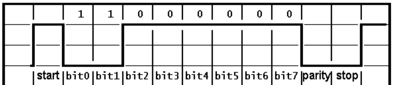
Рисунок 2.21 – Схема передачи фрейма в последовательном интерфейсе
