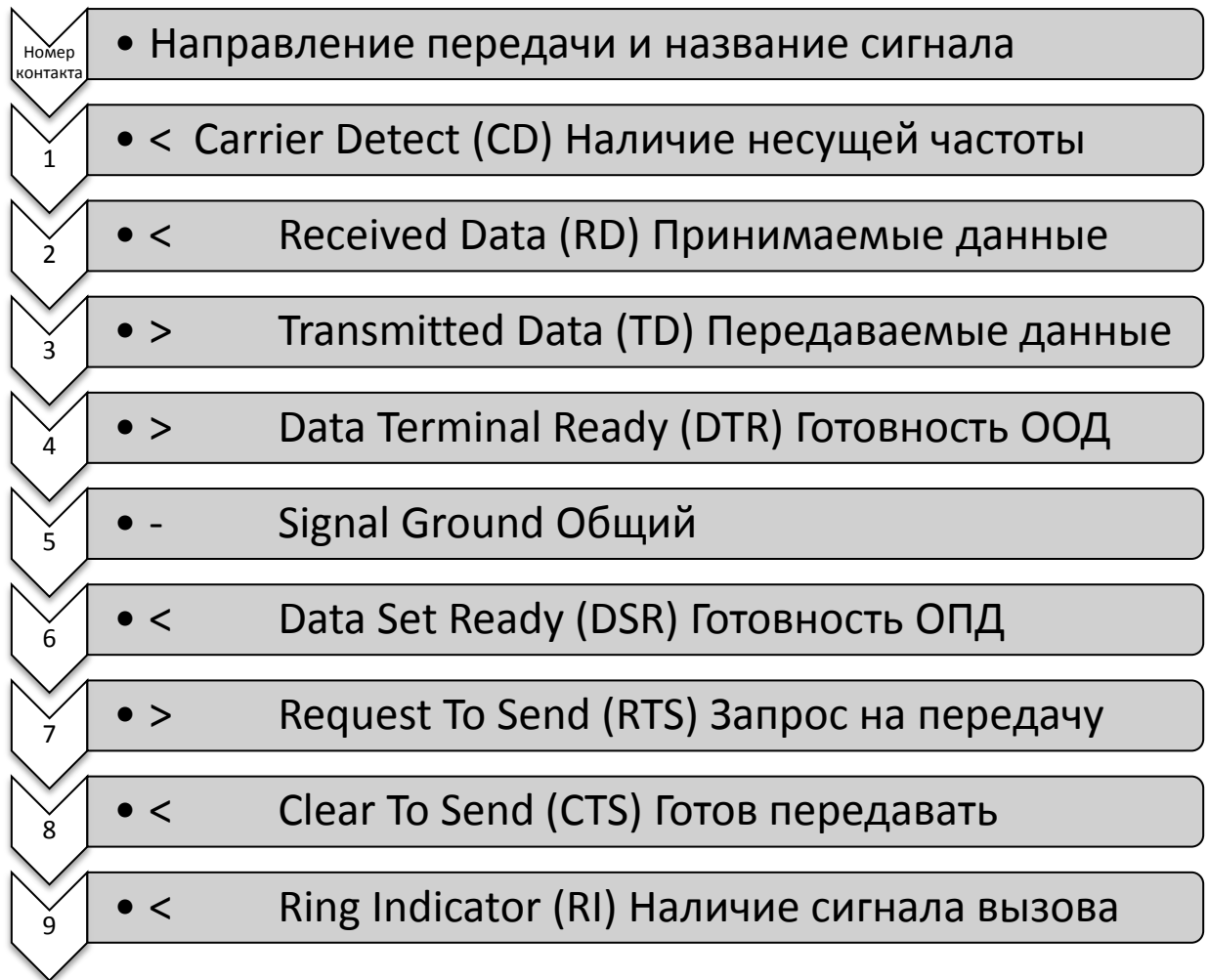
Рисунок 2.20 - Распайка вилки оборудования обработки данных (DTE).
