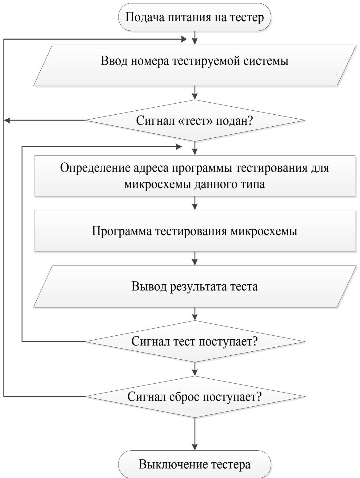
Рисунок 2.24 - Алгоритм работы модуля тестирования компонентов микропроцессорной системы.
