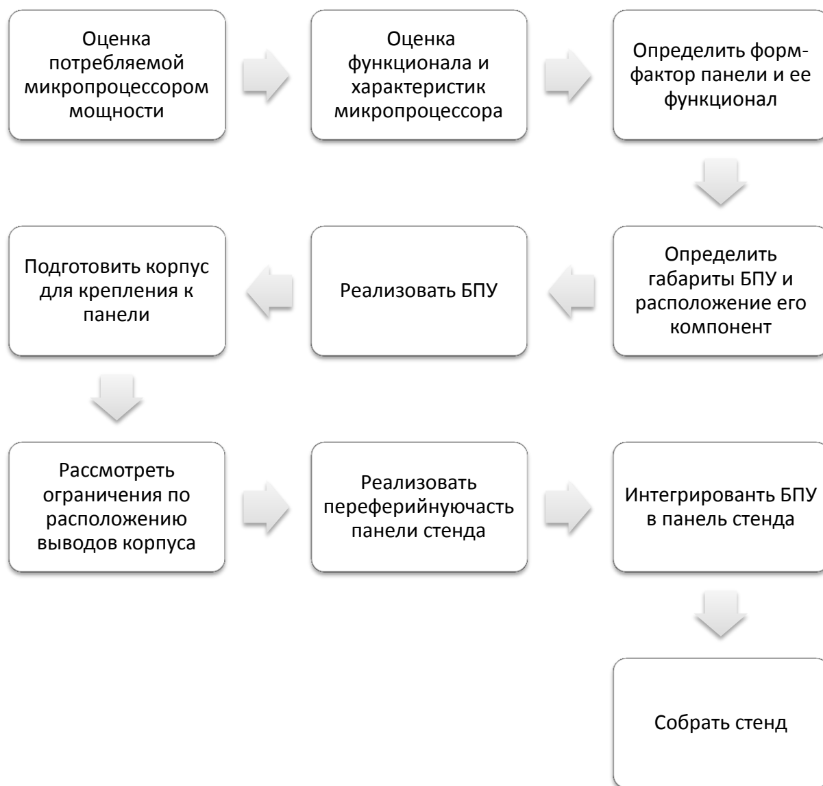
Рисунок 1.2 – Последовательность проектирования стенда для тестирования микропроцессоров.
