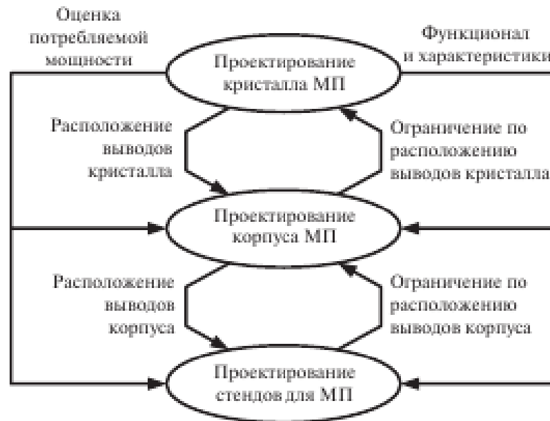
Рисунок 1.1 – Схема зависимости задач проектирования стенда тестирования от задач проектирования микропроцессора
