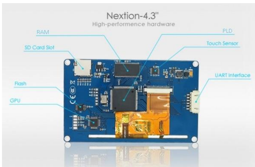
Рисунок 27 – Основные узлы дисплея.
