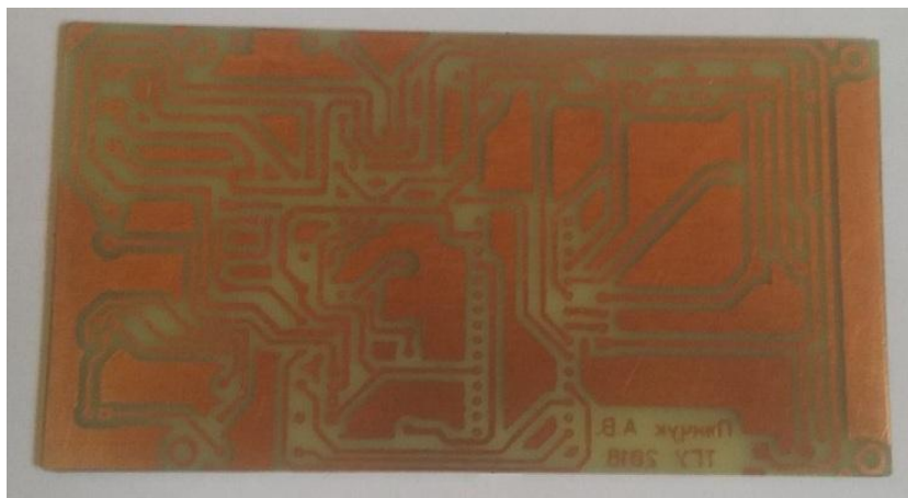
Рисунок 62 – Плата во время травления в химическом растворе.
