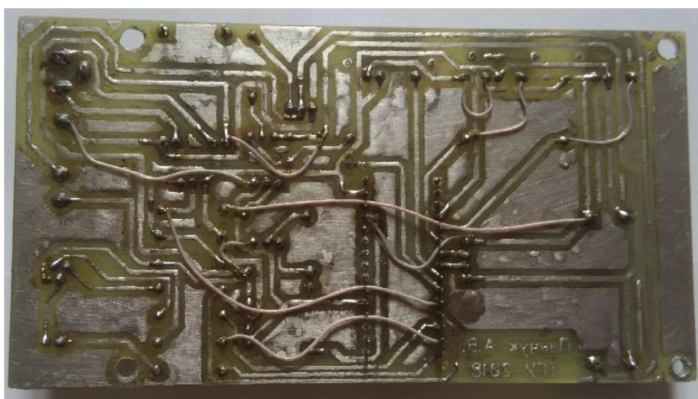
Рисунок 66 – Готовая печатная плата вид снизу.
