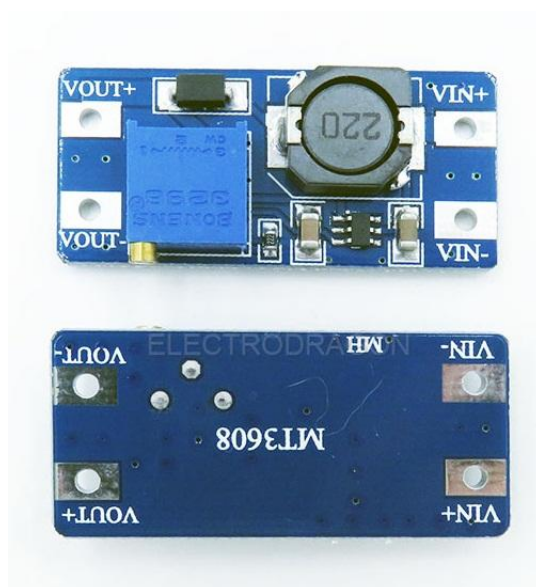
Рисунок 15 – Внешний вид модуля MT3608.
