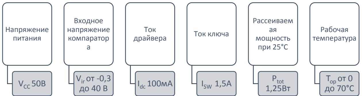
Рисунок 2.12 – Характеристики микросхемы повышающего преобразователя MC34063.
