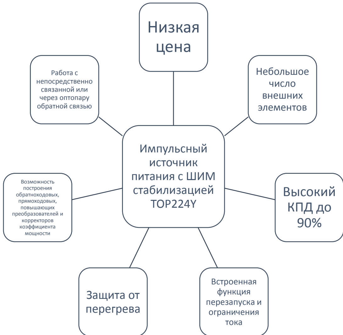
Рисунок 2.15 – Характеристики импульсного источника питания с ШИМ стабилизацией на микросхеме TOP224Y.
