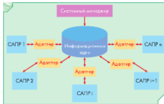
Рисунок 3.2 – Сопряжение интегрируемых САПР с ядром посредством программных адаптеров.
