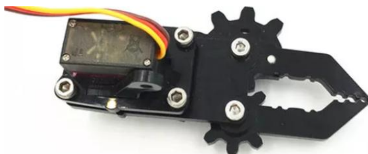
Рисунок 4.5 – Сборка рабочего органа управления
