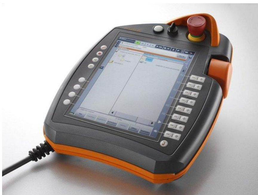
Рисунок 1.1 – Пульт управления KUKA smartPAD
