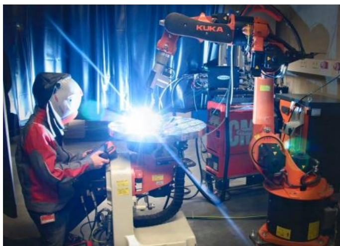
Рисунок 1.2 - Робот KUKA KR 16-2 в процессе выполнения операции сварки
