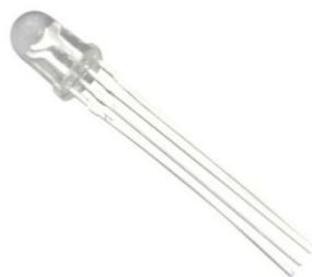
Рисунок 2.10 – RGB светодиод BL-L515RGBW-CC
