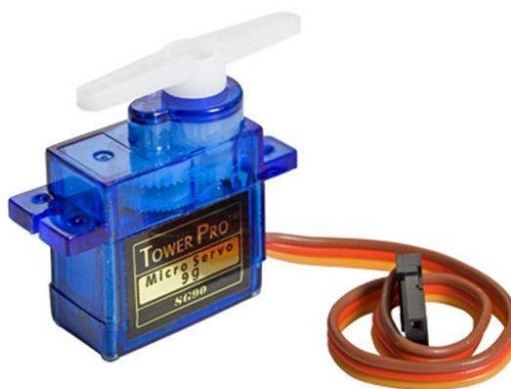
Рисунок 1.5 – Сервопривод SG90, внешний вид
