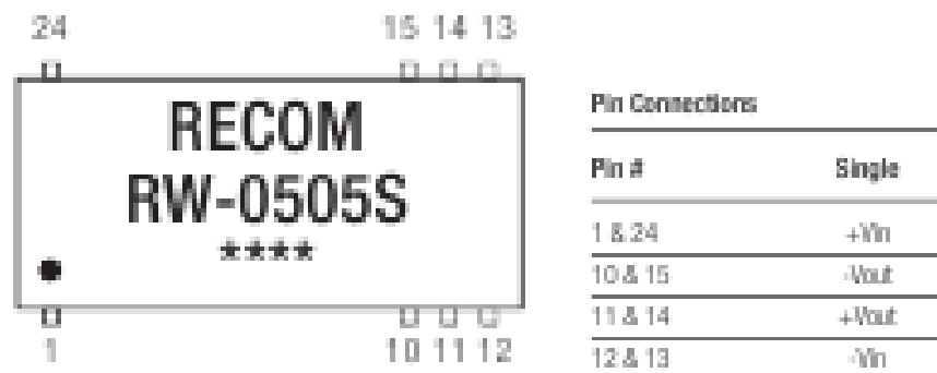
Рисунок 2.34 - Назначение и расположение выводов DC-DC преобразователя RW0505S.
