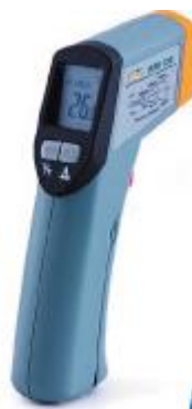
Рисунок 1.6 - Бесконтактный инфракрасный радиационный пирометр АКПП-9302.
