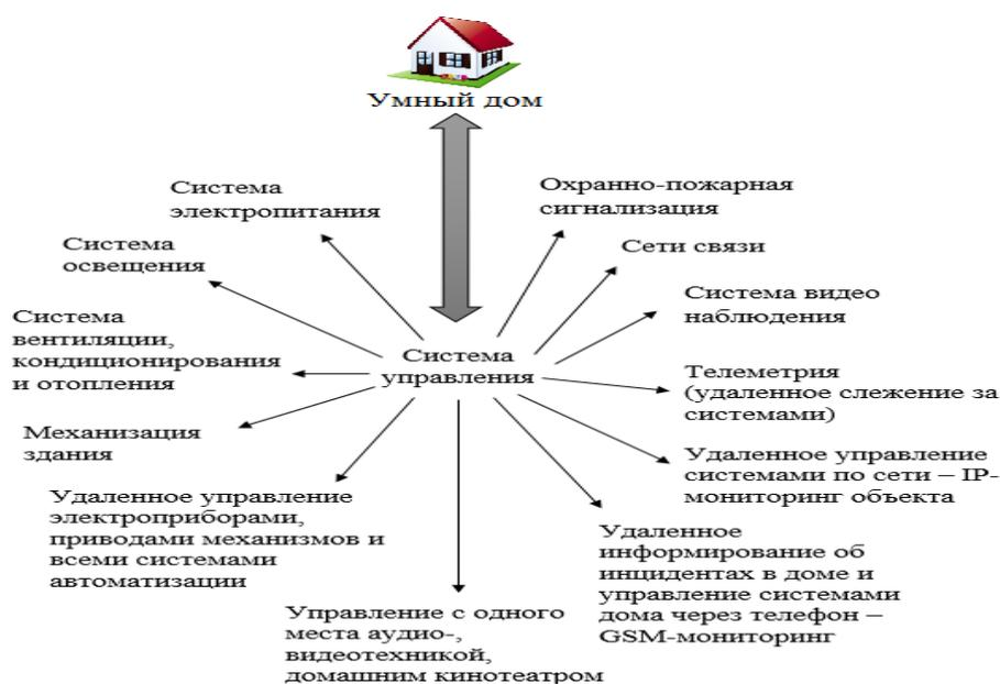
Рисунок 1 - Схема системы управления умного дома.
