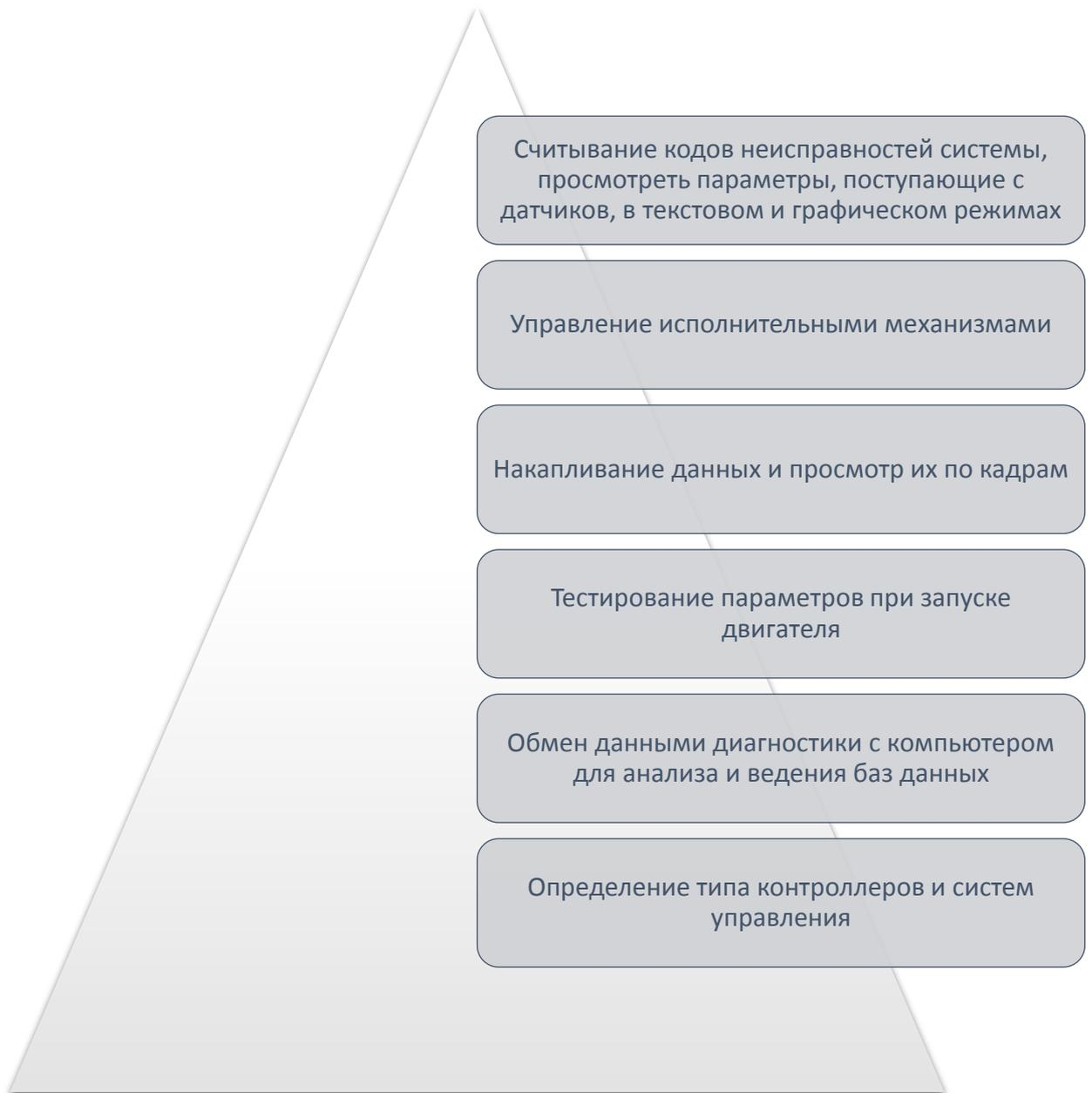
Рисунок 1.5 – Функции тестера ДСТ-2М.
