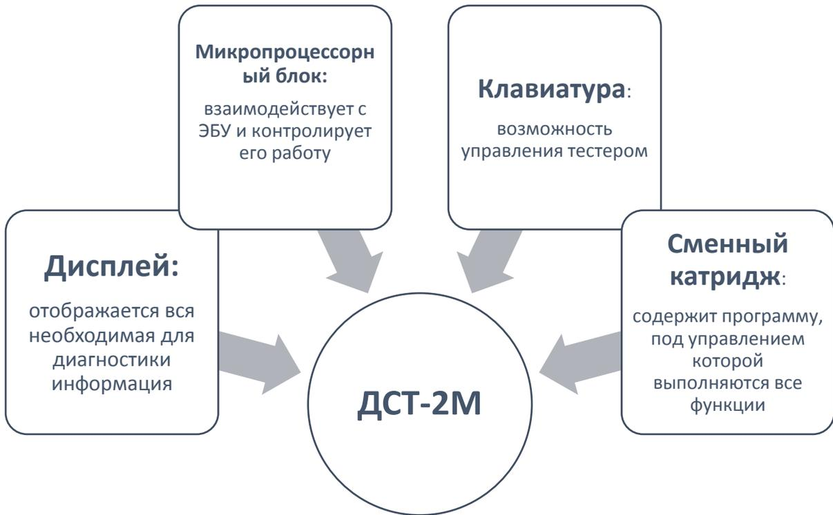
Рисунок 1.4 - Компоненты-составляющие тестера «DST-2M».
