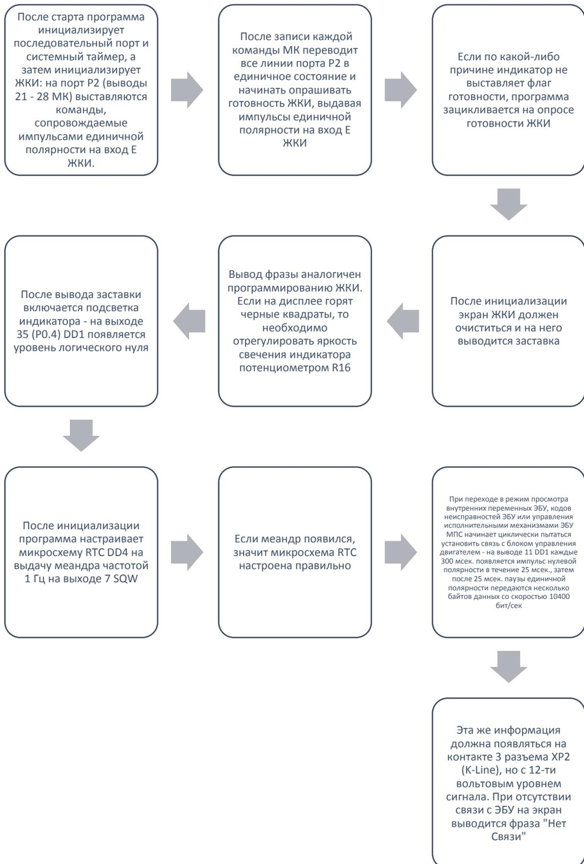
Рисунок 3.8 – Описание процесса тестирования программной составляющей микропроцессорной системы управления исполнительными механизмами
