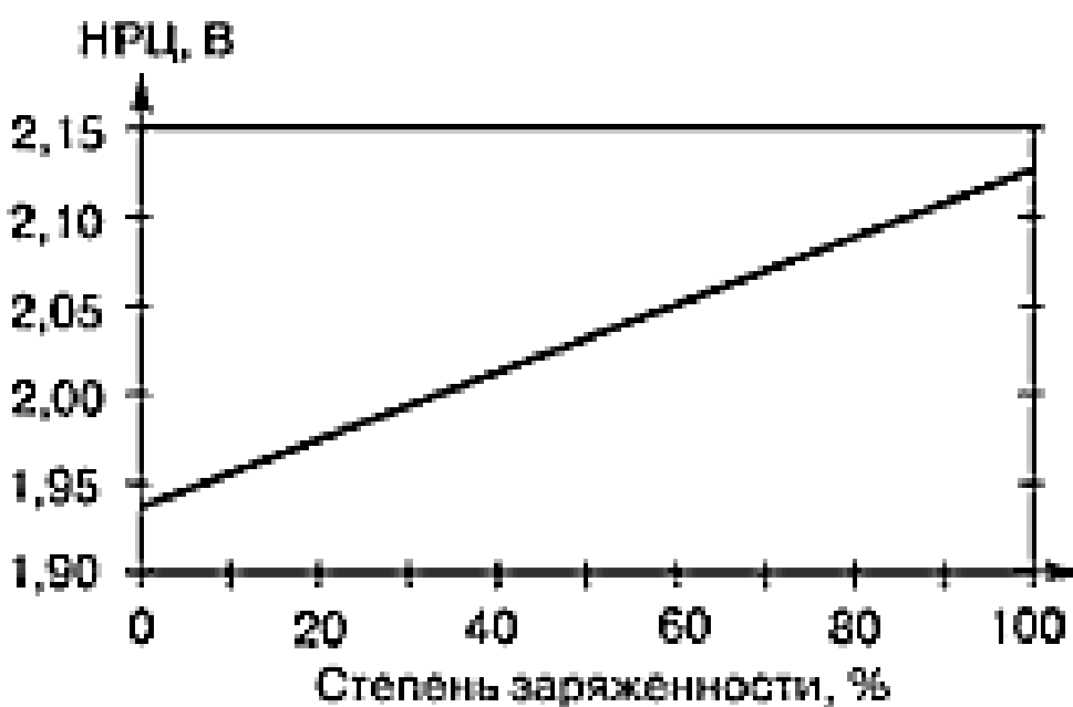
Рисунок 1.17 – Связь между зарядом и напряжением на аккумуляторе.
