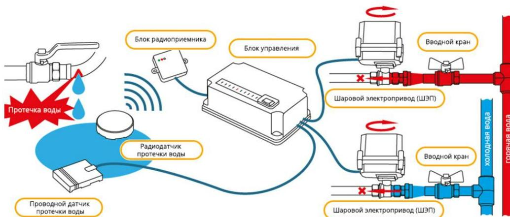
Рисунок 9 — Пример построения системы защиты от протечек воды.
