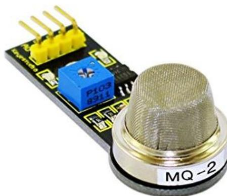
Рисунок 25 — Датчик газа MQ-2.
