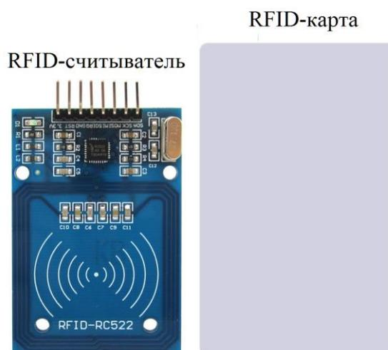
Рисунок 28 — RFID-система для платформы Arduino.
