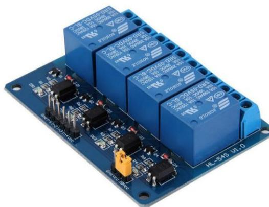
Рисунок 30 — Модуль четырехканального реле для Arduino.
