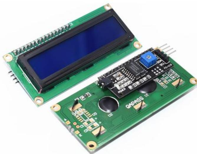
Рисунок 23 — LCD-дисплей 16x2.
