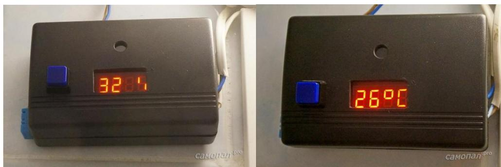
Рисунок 1.1 – Внешний вид Контроллера управления вытяжным вентилятором с WiFi. Отображение на дисплее величины влажности и знака «%». Отображение на дисплее величины температуры и знака «°»
