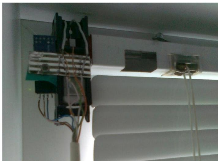
Рисунок 4.7 – Модифицированные жалюзи с положением ламелей «закрыто»
