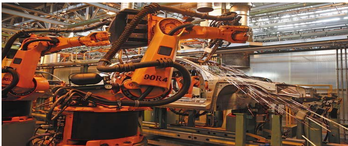
Рисунок 1 – Сварка кузова автомобиля с использованием автопромышленного манипулятора
