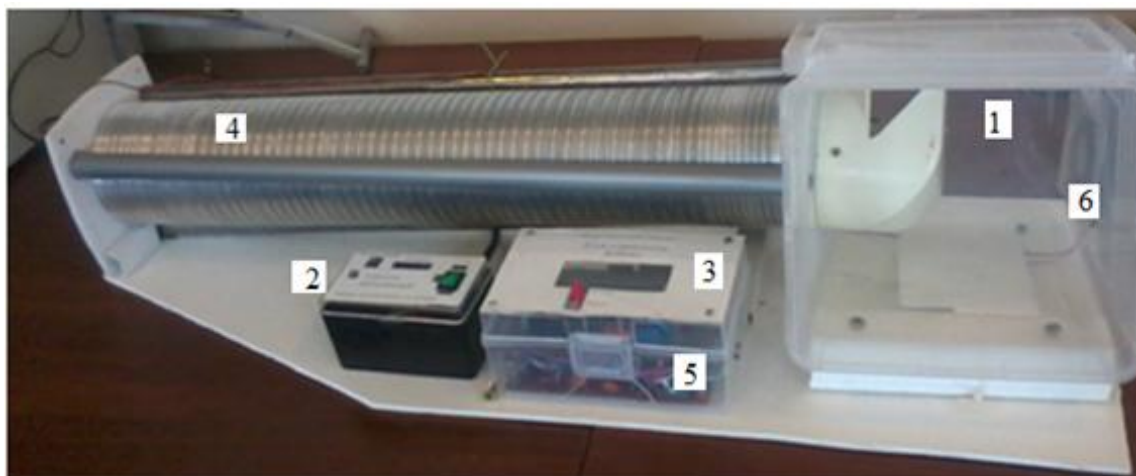
Рисунок 3.1 – Внешний вид термостата с обозначением составных частей
