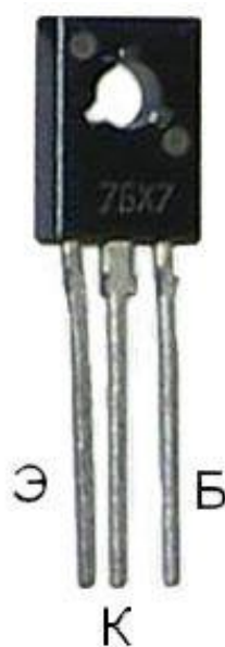
Рисунок 2.17 - Транзистор КТ817 в корпусе ТО126
