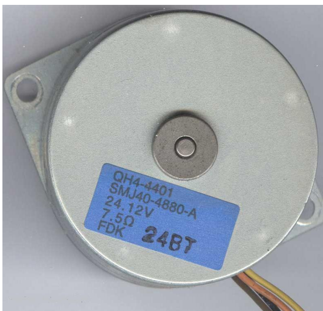
Рисунок 2.6 - Шаговый двигатель QH4-4401
