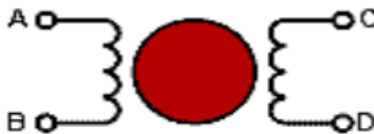
Рисунок 2.7 - Схема биполярного шагового двигателя
