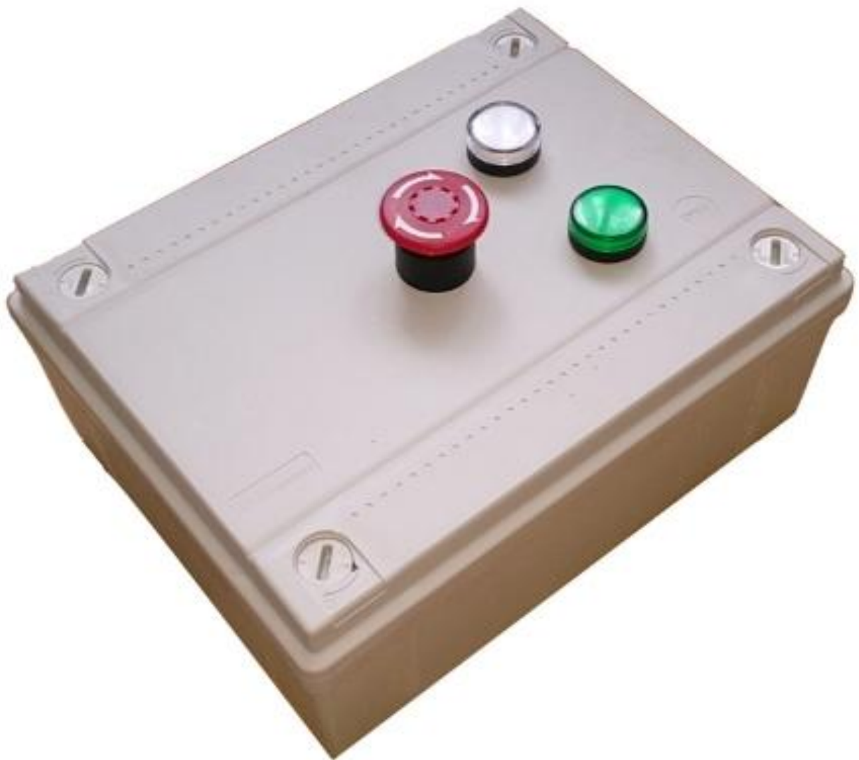
Рисунок 35 – Портативная система дистанционного управления асинхронным электродвигателем.
