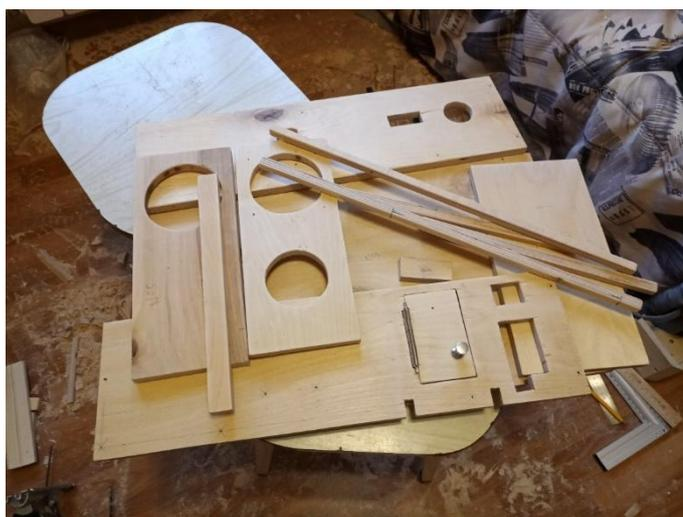
Рисунок 56 - Разобрали стенд. Отшлифовали отверстия под датчики. Отшлифовали поверхности стен.
