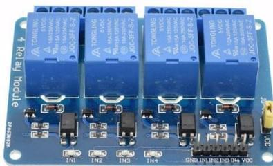
Рисунок 15 - Четырех канальный блок реле с гальванической развязкой.
