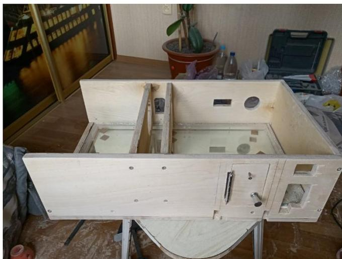
Рисунок 59 - Собрали стенд заново. Отшлифовали стыки между панелями.
