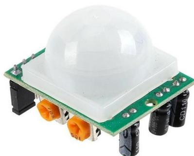
Рисунок 26 – Инфракрасный датчик присутствия.
