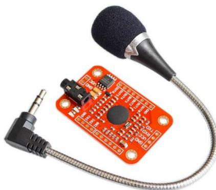
Рисунок 17 - Модуль распознавания голоса V3.
