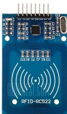
Рисунок 25 - RFID-label RC522 13.56MHz.
