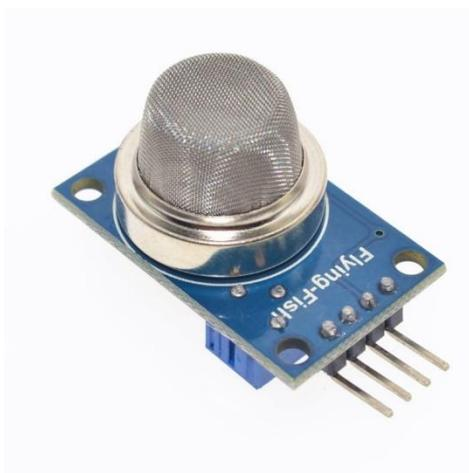
Рисунок 20 - Датчик «Анализатор воздуха» MQ-6.
