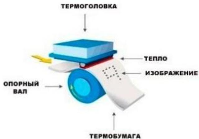
Рисунок 3.5 – Устройство термопечати
