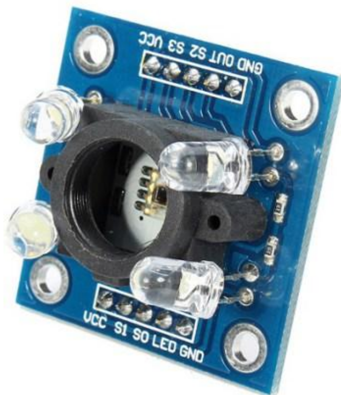
Рисунок 6.8 – Модуль датчика цвета на микросхеме TCS3200
