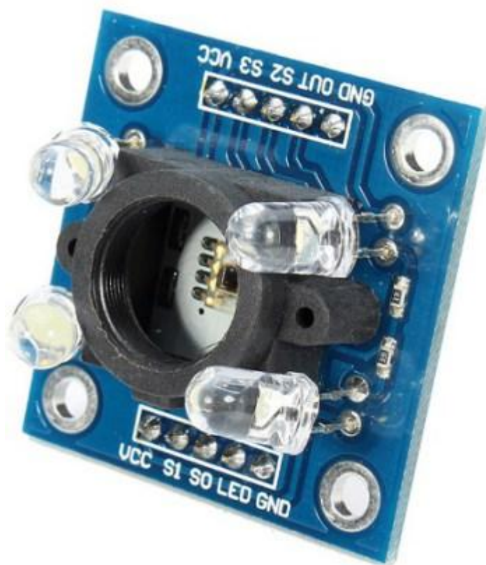
Рисунок 5.4 – Модуль датчика цвета на микросхеме TCS3200
