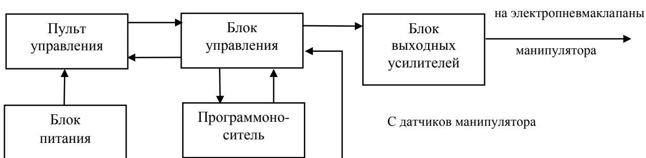
Рисунок 19 – ЭЦПУ-6030 схема структурная
