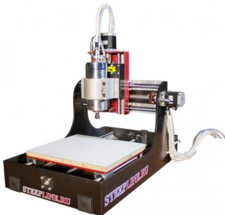
Рисунок 1.2 – Сверлильный станок для производства печатных плат с ЧПУ Steepline
