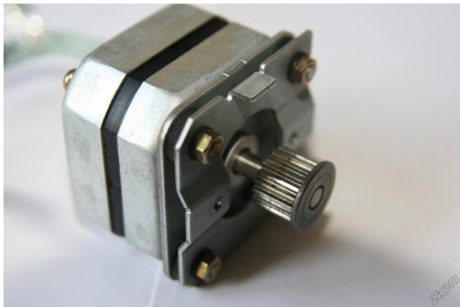
Рисунок 5.2 – Шаговый двигатель ЕМ-188.
