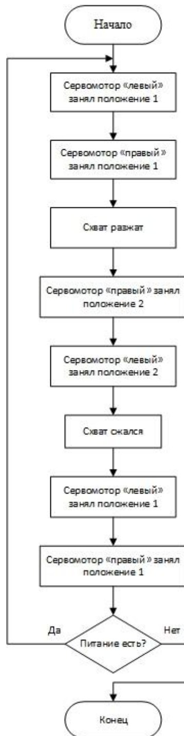
Рисунок 5.1.1.3 – Блок схема работы 1 цикла руки-манипулятора.
