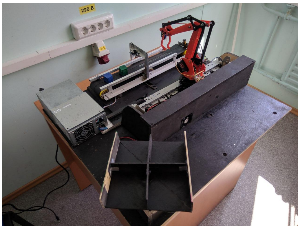
Рисунок 1 - Лабораторный стенд «Автоматизированная складская система»
