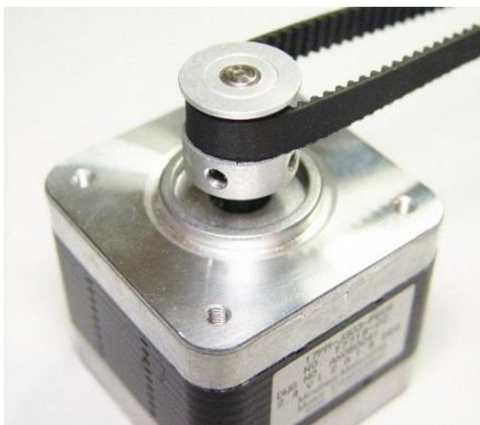
Рисунок 2.2 – Шаговый двигатель с ременной передачей
