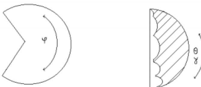
Рисунок 3.9 – Рабочая зона манипулятора, который работает в ангулярной системе координат
