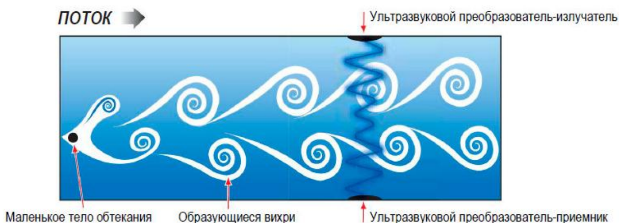
Рисунок 10 – Принцип измерения вихревого расходомера
