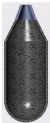
Рисунок 27 – Создание емкости с изменением толщины стенок, материала и верхнего края.
